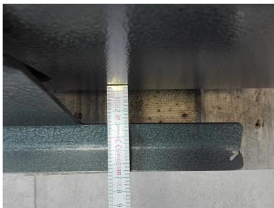
Rysunek 13. Ustawienie przesłony przy paleniu z mocą nominalną - drewno.
