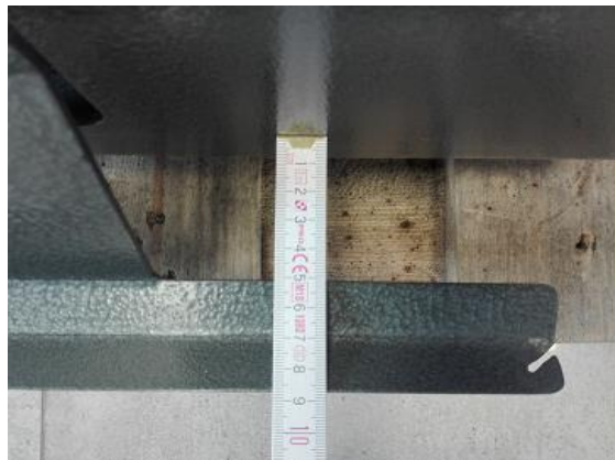
Rysunek 12. Ustawienie przesłony przy paleniu z mocą nominalną - węgiel.
